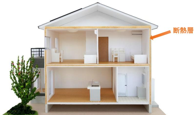
参考までに、ロックウールなどの繊維系断熱材を柱間に充てんする「木造軸組の壁構成」を例示します。
